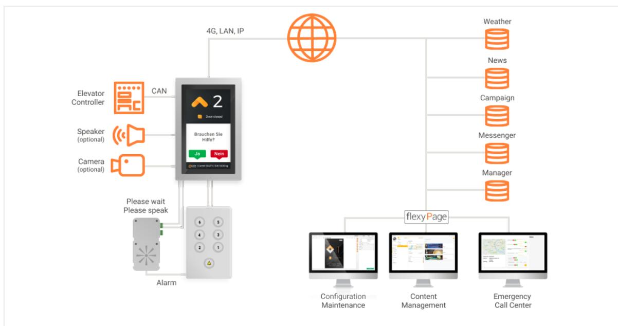
Abbildung: flexyPage Display als Kabinenstandanzeige, Multimedia Display, Hörbehinderten Display mit Anschlüssen für die Innenrufe und eine Kamera
